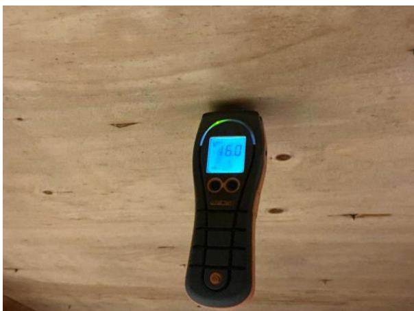
Bild 1: Utvändigt, Vind, Huset är självdragsventilerat, se riskanalysen Mikrobiell påväxt noterades på underlagstaket Se riskanalys Inga förhöjda fuktvärden notera...
