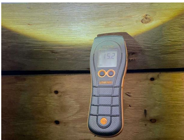
Bild 2: Utvändigt, Vind, Huset är självdragsventilerat, se riskanalysen Mikrobiell påväxt noterades på underlagstaket Se riskanalys Inga förhöjda fuktvärden notera...
